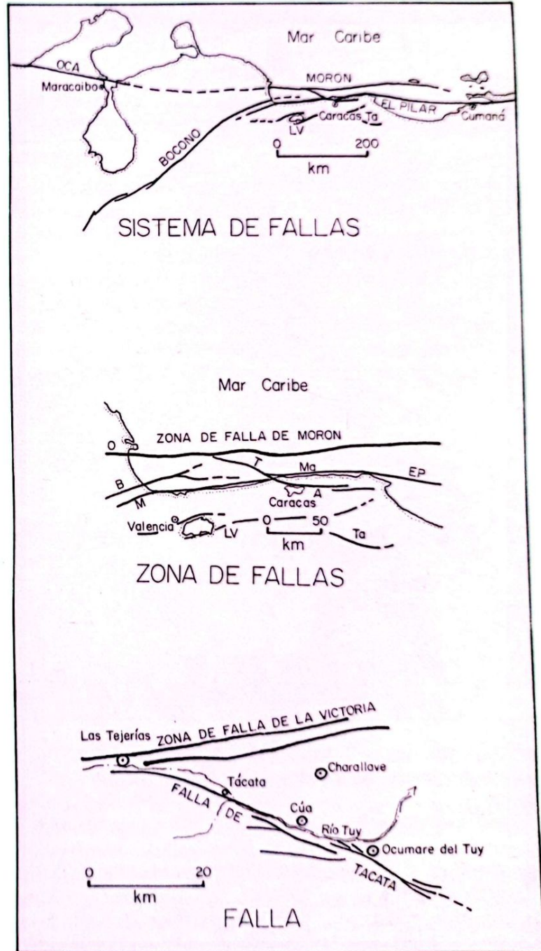
Figura 23. Dimensiones relativas de los sistemas de fallas, zonas de fallas y fallas (según Crowell, 1975). Un sistema de fallas consiste en un grupo de varias fallas formando una faja ancha y larga (cientos de kilómetros); este ejemplo representa el sistema de fallas de Boconó-Oca-Morón-El Pilar, el cual es el sistema de fallas más importante de Venezuela que genera la mayor parte de la actividad sísmica del país. Asociado a este sistema, se encuentra la zona de fallas de La Victoria (LV) y la falla de Táchata (Ta). Una zona de fallas consiste de una faja relativamente angosta (20 a 30 km.) de fracturas, las cuales se cruzan, unen y divergen; en este caso, se ilustra la zona de fallas de Morón, la cual representa el segmento central del sistema de fallas de Boconó (B)-Oca (O)-Morón (M)-El Pilar (EP); además están asociados a la zona de fallas de Morón, las fallas de Tacagua (T)-El Avila (A) y Macuto (Ma). Símbolos: LV: zona de fallas de La Victoria; TA: falla de Táchata. Una falla consiste de la fractura principal, a lo largo de la cual se produce ruptura; en este caso, se ilustra la falla de Táchata, perteneciente a la zona de fallas de La Victoria. Nótese la diferencia en las escalas de cada una de las ilustraciones.
